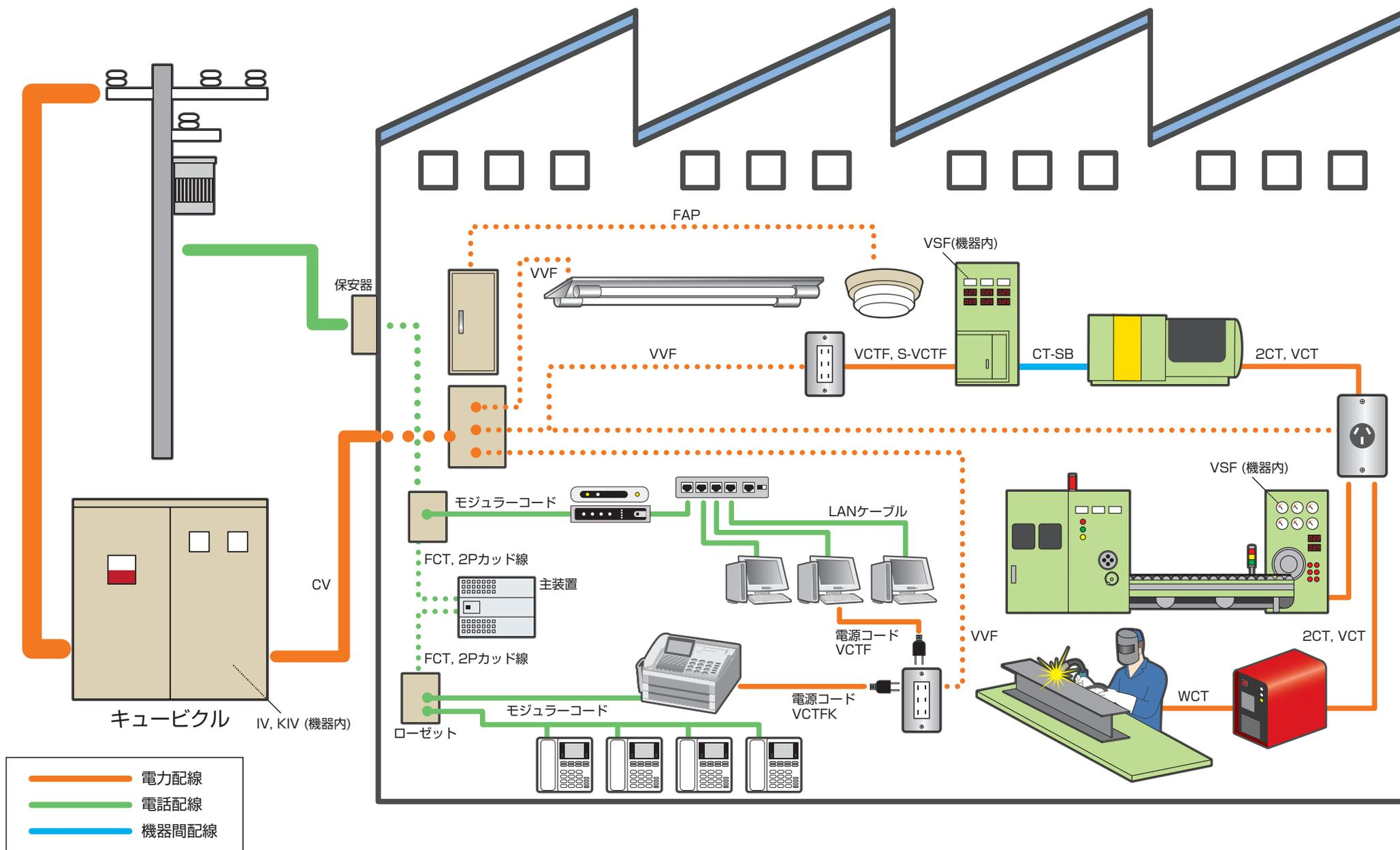
※実線は露出配線、破線は埋込み配線
