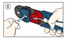
かしめ工具を用いて確実にかしめる。
